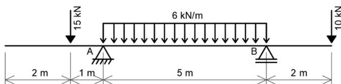
Com base nessa figura, assinale a alternativa que indica CORRETAMENTE as reações de apoio da viga nos pontos A e B, respectivamente.
