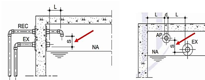
Supondo que a tubulação de recalque ( $REC$ ) utilizada em um determinado reservatório apresenta diâmetro externo de 32mm (diâmetro interno ( $d$ ) de aproximadamente 28 mm), a alternativa que indica um valor CORRETO para a separação atmosférica desse caso específico é:
